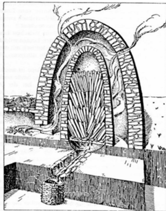
Rekonstruktionsversuch eines Pechofens (nach Barthel)
